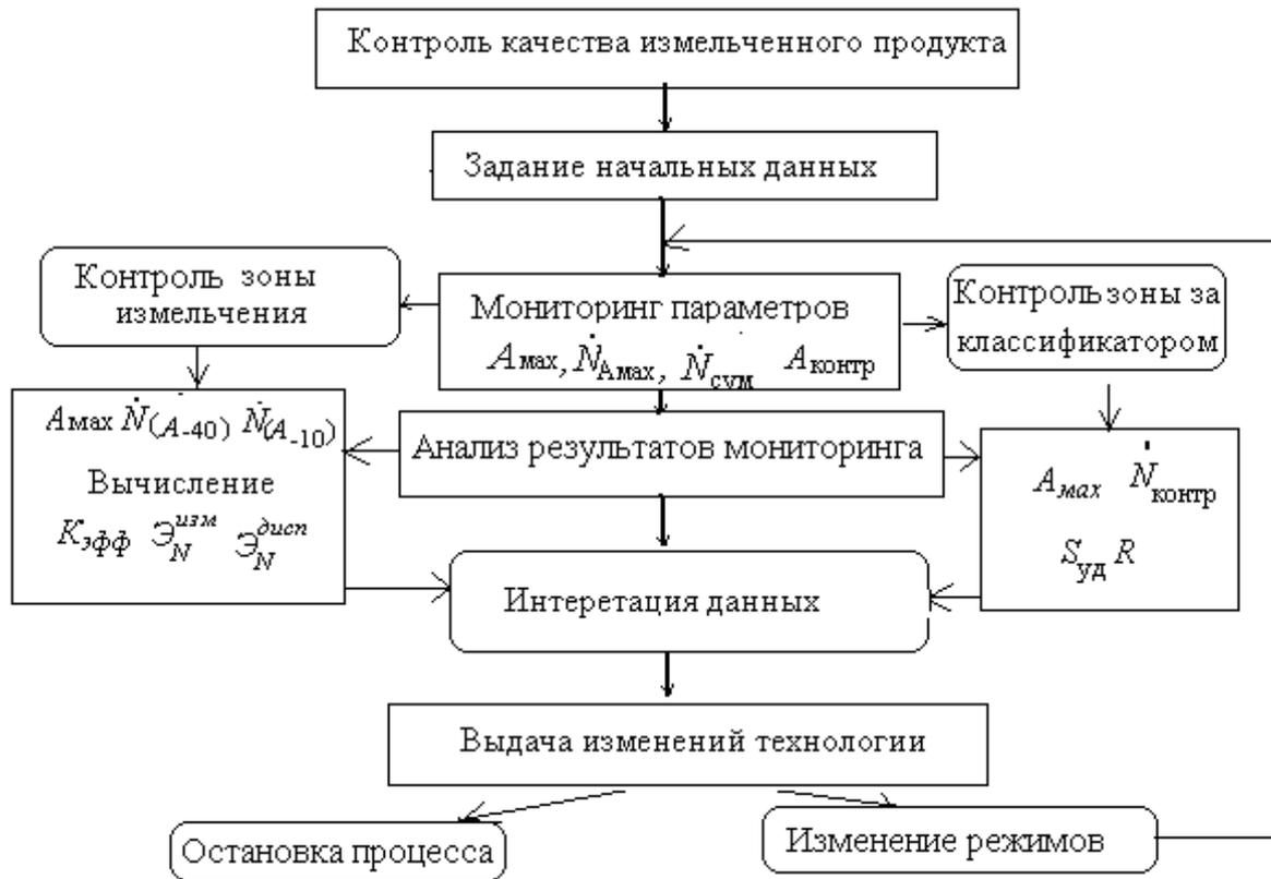
Рис. 6. Блок-схема мониторинга и расчета акустических критериев для оптимизации дисперсности продукта струйного измельчения
