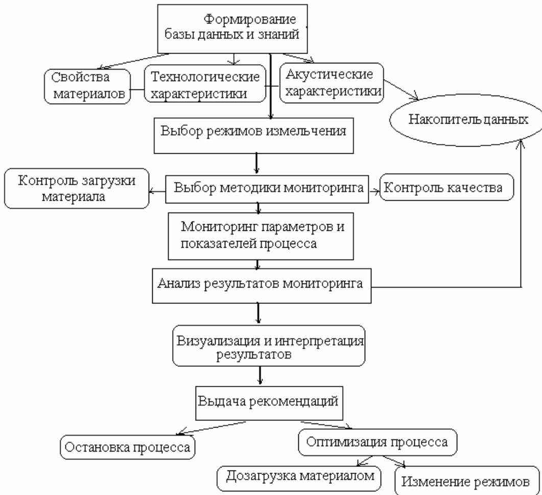
Рис. 6. Информационная система процесса струйного измельчения на основе акустического мониторинга
