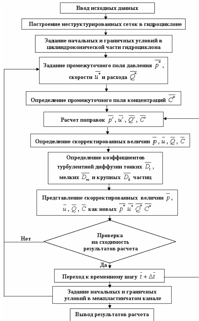
Рис. 6. Блок-схема программы расчета гидродинамических параметров суспензии в противоточном гидроциклоне с перечисткой
