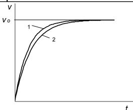
Кинетика разгона равнопадаемых частиц ильменита (1) и кварца (2)
