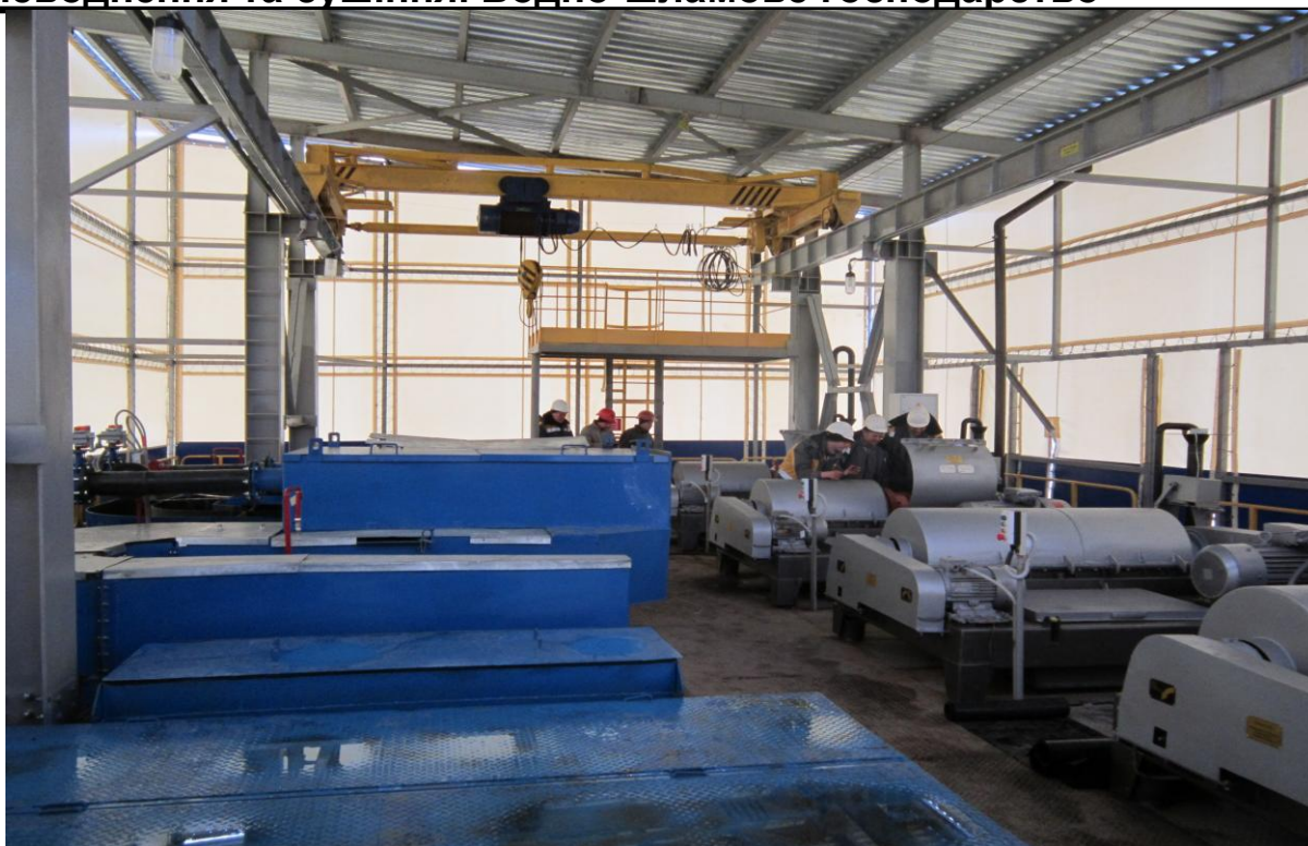
Рис. 3. Центрифуги ОГШ 461Л-01 внутрі Модуля
