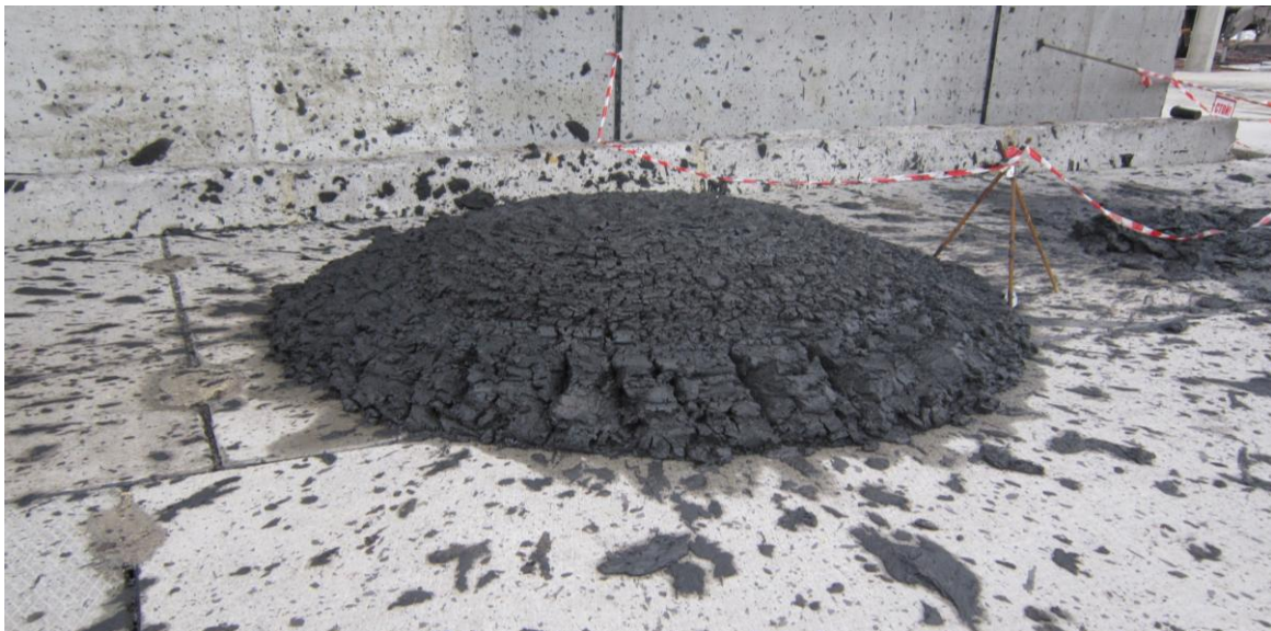
Рис. 4. Вид осаду центрифуги ОГШ 461Л-01
