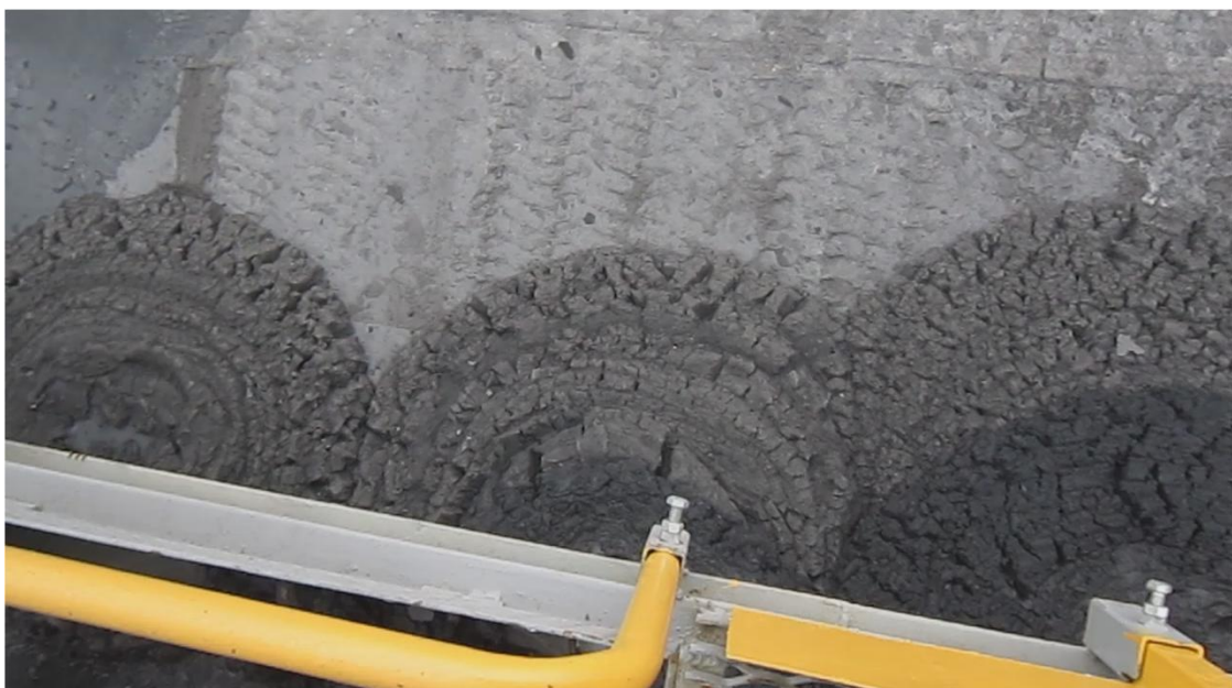
Рис. 5. Вигружений осадок із декількох центрифуг ОГШ 461Л-01 (вид зверху)
